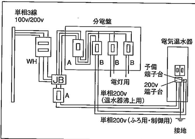
WH:電力量計(2時間メーター) A:親配線用遮断器 B:配線用遮断器 JB:分岐ボックス
