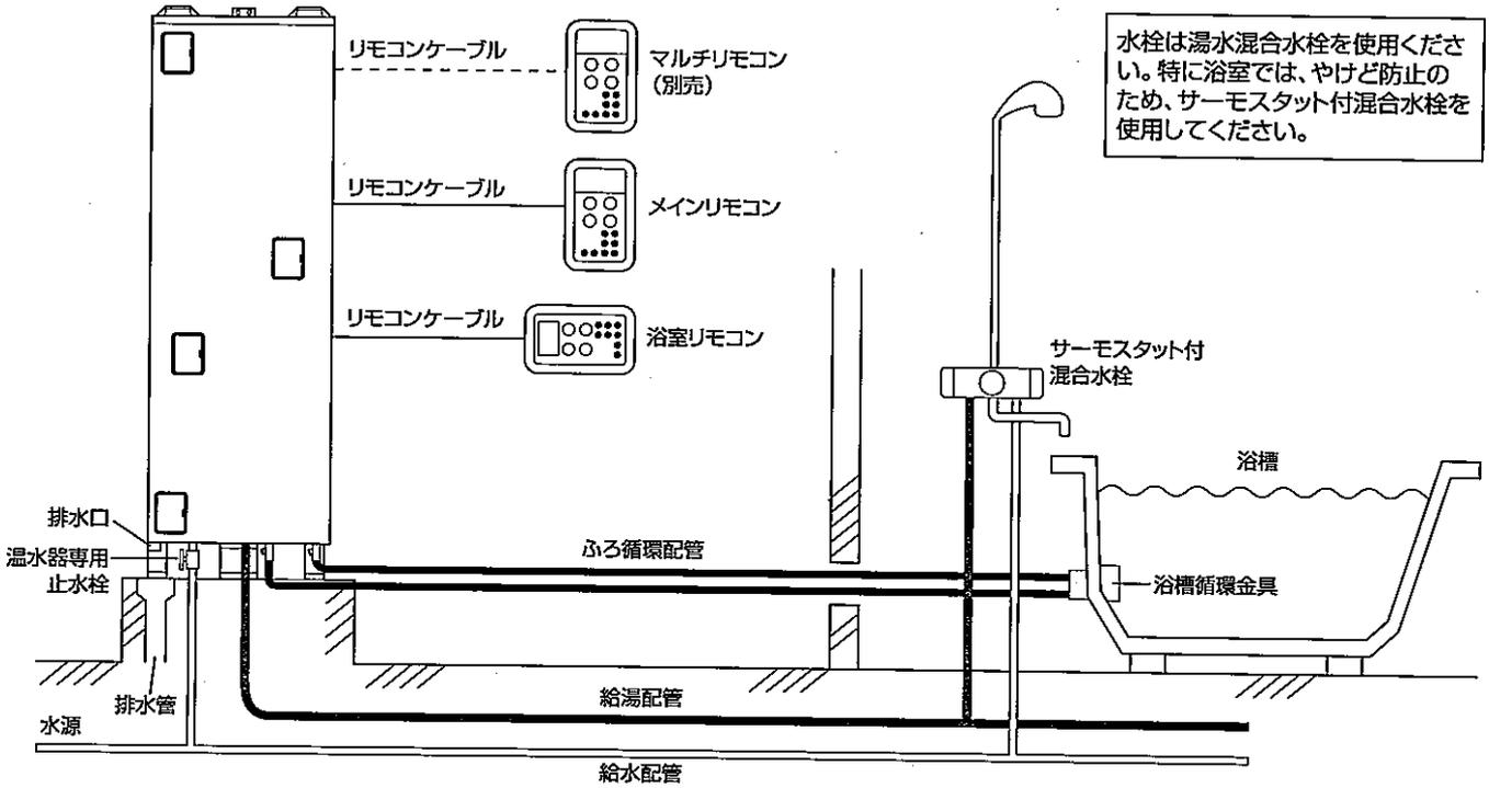
水栓は湯水混合水栓を使用ください。特に浴室では、やけど防止のため、サーモスタット付混合水栓を使用してください。
