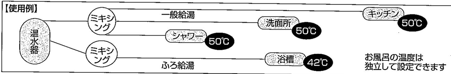
**お願い** ●サーモスタート付湯水混合栓の場合は、リモコンの給湯温度の設定は使用するお湯の温度よりも約10℃高めに設定してください。
