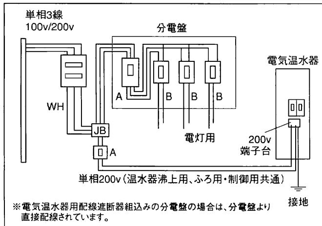
■深夜電力通電制御型(8時間)の例
