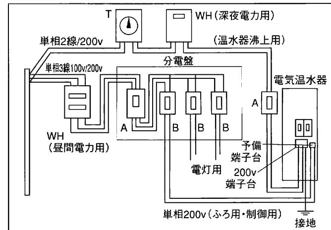
WH:電力量計 A:親配線用遮断器 B:配線用遮断器 T:タイムスイッチ
