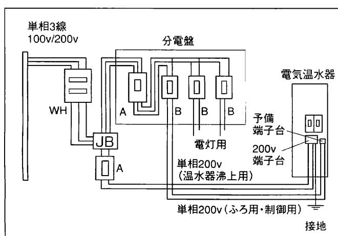
WH:電力量計(2時間メーター) A:親配線用遮断器 B:配線用遮断器
