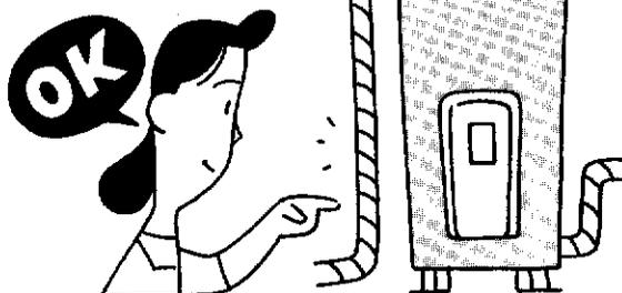
温水器の脚がアンカーボルトで固定してあるか確認すること。
