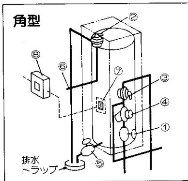
1 温水器の専用止水栓①を閉める。
